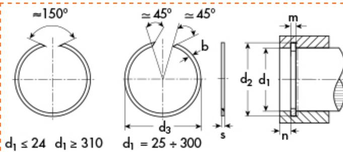
DIN 9928 di spallamento tipo **SB** - per fori
